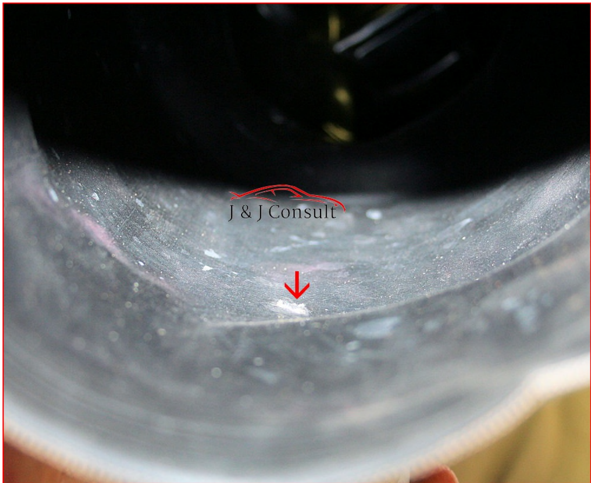
8. Foto af luftfjederens indvendige del hvor materialet er stukket indad.
